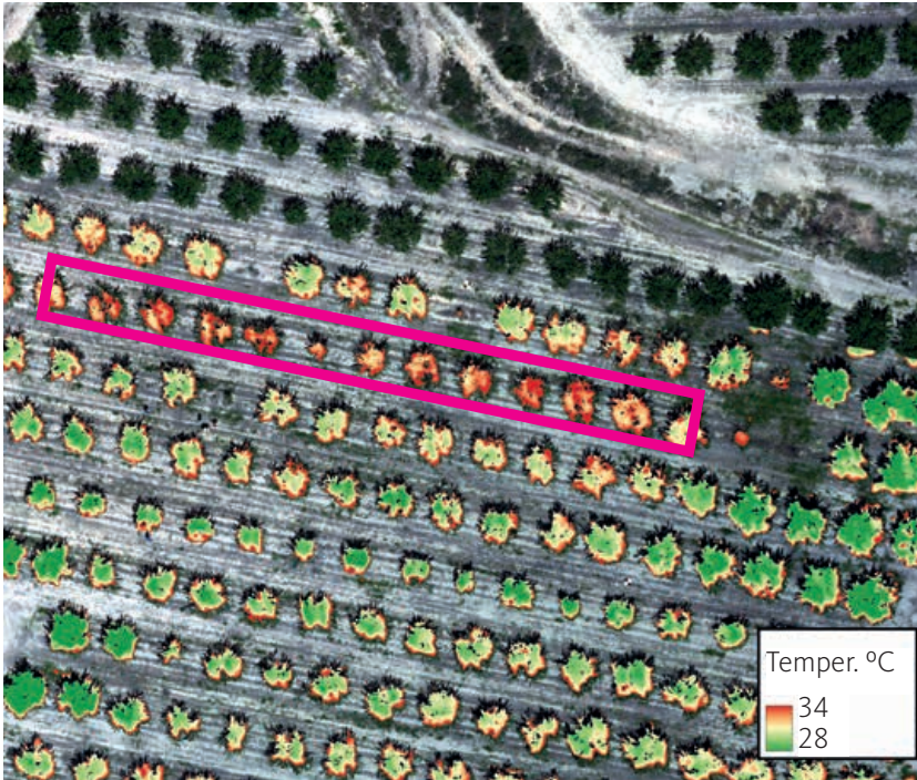
02. Imatges tèrmiques obtingudes amb dron. Font: IRTA
